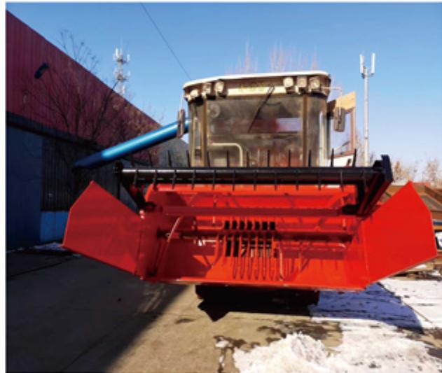
中型玉米脱粒机的常见故障：玉米粒破碎过多。脱粒间隙过小、滚筒转速过高以及喂入物不均匀或谷物过干、过湿都是产生此故障的原因。出现此种情况时，应检查脱粒间隙是否正确，另外还需检查滚筒皮带轮与动力皮带轮选配是否合理、准确。如有不妥，应进行调整或更换。另外，应尽量保证喂入均匀，谷物干多喂，湿度大少喂。玉米芯里含有玉米穗。产生此故障时，应检查脱粒机是否存在以下问题：不在满负荷下作业；喂入不均匀；脱粒机转速不符合要求；穗轴出口插板调节不当；玉米穗在料斗里架空；石块或残屑堵塞短凹板；玉米穗水分过大；滚筒调整不当。在确定故障原因后，应逐一调整喂入量，调整转速，用木棒敲打料斗，清理短凹板，烘干晾晒玉米穗，检查滚筒，更换钉齿。海太机械的企业理念是“勇于开拓，不断创新，以质量求生存，以效益促发展”。湖南自走式玉米脱粒机哪家好
