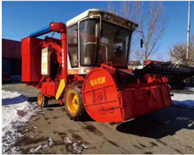
在运用玉米脱粒机的过程中应留意事项？1、中型玉米脱粒机厂家由于脱粒机任务环境非常恶劣，因此事前要对参与作业的人员停止平安操作教导，使其了解操作规程和平安学问，如衣袖要扎紧、应戴口罩和防护眼镜等。2、运用前必需认真查看转变部位能否灵活无磕碰，调理组织能否正常，平安设备能否完整有用；要保证机内无杂物，各润滑部位要加注润滑油。3、开机前应整理作业场所，不得放一些与脱粒无关的杂物；要遏止少年在场所边上玩耍，防止发作事端。4、任务时玉米棒喂入要平均，谨防石块、木棍和其它硬物喂入机内。5、传动皮带的接头要坚固；制止在机器任务时摘挂皮带或将任何物体触摸传动部位。6、配套动力与脱粒机之间的传动比要契合请求，防止因脱粒机转速过高，振荡猛烈，使零件损坏或紧固件松动而引发人身伤害事端。7、不能接轮作业时间过长，普通任务8小时左右要停机检查、调整和润滑，以防抵触严峻招致磨损、发热或变形。8、脱粒机普通都用柴油机作动力，应在排气管上戴防火罩，防止火灾。9、脱粒机在作业过程中如出缺点，应停机后再停止修理和调整。
